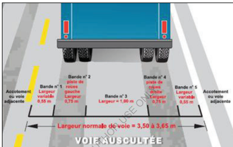
Figure III.18 – Détails des bandes d'auscultation pour la fissuration (dégradation) (MTQ-AIMQ 2002).
